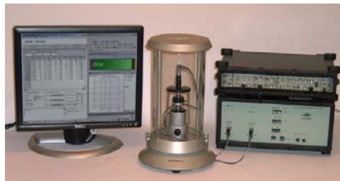
Фиг.7 Система за реципрочно калибриране на микрофони
