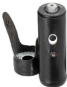
Фиг. 7 Вибрационен калибратор, тип 4294
