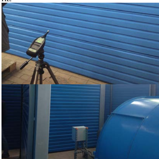
Фиг. 9 Реални измервания на шум в работна среда
