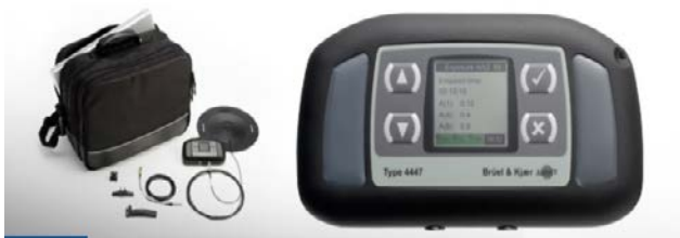
Фиг. 4 Вибрационен анализатор тип 4447
